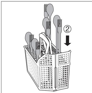
Für größere Besteckteile, wie z.B. Schneebesen, kann eine Hälfte des Besteckgitters weggelassen werden.
