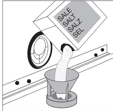
**i** Es ist unbedenklich, dass beim Einfüllen von Spezialsalz Wasser überläuft.
